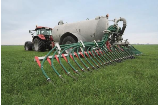
Bild 1: Das Universalgestänge UniSpread kann wahlweise mit Schleppschlauch- oder Schleppschuhtechnik ausgerüstet werden.
