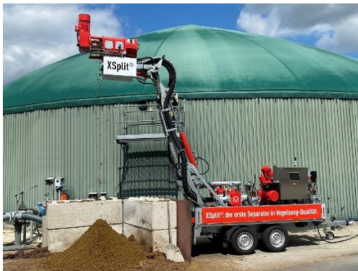
Bild 3: Der Pressschneckenseparator XSplit erreicht einen TS-Gehalt im Feststoffanteil von bis zu 40 Prozent.
