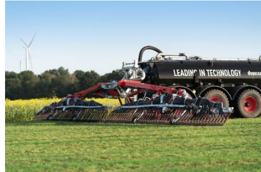
Bild 2: Das Schleppschuhgestänge BlackBird zur präzisen, wurzelnahen Gülleapplikation.
