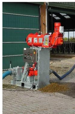
**Bild 2:** Mit dem XSplit Compact zeigt Vogelsang eine kompakte Systemlösung zur Fest-Flüssig-Trennung von Gülle und Gärresten.
