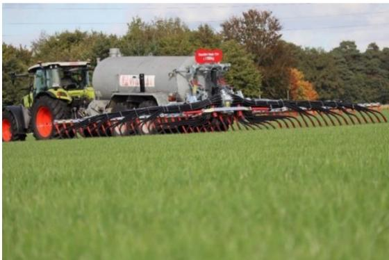
**Bild 1:** BlackBird Single, hier mit 12 Metern Arbeitsbreite: schlankes Schleppschuhgestänge für die einfache Nachrüstung.
