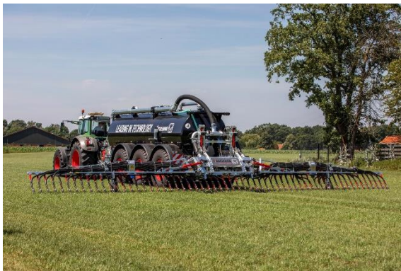
Bild 3: Schlepptschuhgestänge BlackBird Pro, hier in einer Arbeitsbreite von 15 Metern.
