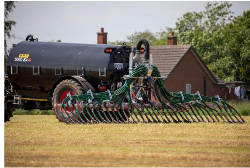
Bild 2: Das flexible Universalgestänge UniSpread bringt die Gülle emissionsarm aus.
