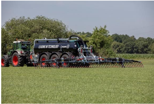
Bild 1: Das Schleppschuhgestänge BlackBird (hier in 15 Metern Arbeitsbreite) steht für eine präzise und wirtschaftliche Gülleausbringung.
