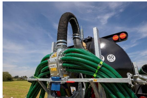
Bild 4: Der Exaktverteiler ExaCut ECL zeichnet sich durch die hohe und konstante Schneidleistung und die gleichmäßige Verteilung der Gülle auf alle Schläuche aus.
