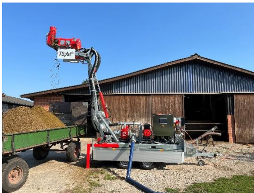
Bild 1: Mit dem Pressschneckenseparator XSplit (hier als Systemlösung) lassen sich Gülle und Gärreste effizient aufbereiten.
